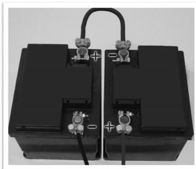
ATENÇÃO: Baterias do tipo “BAIXA MANUTENÇÃO” exigem reposição de água destilada. Baterias do tipo “SELADA” tem validade média de 2 anos, devendo ser trocadas após esse período. Para um bom acabamento estético utilize a caixa para baterias da Walmonof modelo CB2.
